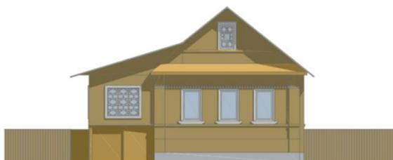
**Хорошо.** Кондиционеров и иных элементов инженерного оборудования нет на главном фасаде, они размещены на второстепенных фасадах
