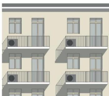
**Допустимо.** Кондиционер спрятан в специальной нише на балконе (для зданий типов 1 и 2 на схеме)
