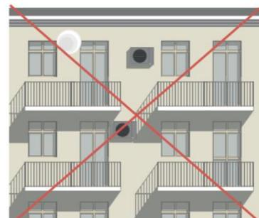
**Плохо.** На лицевом фасаде, выходящем на туристический маршрут, размещены блоки кондиционеров и спутниковая антенна
